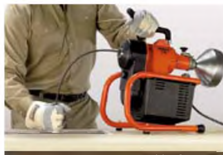
РАБОТА С МАЛЫМ БАРАБАНОМ СО СПИРАЛЬЮ 8ММ
