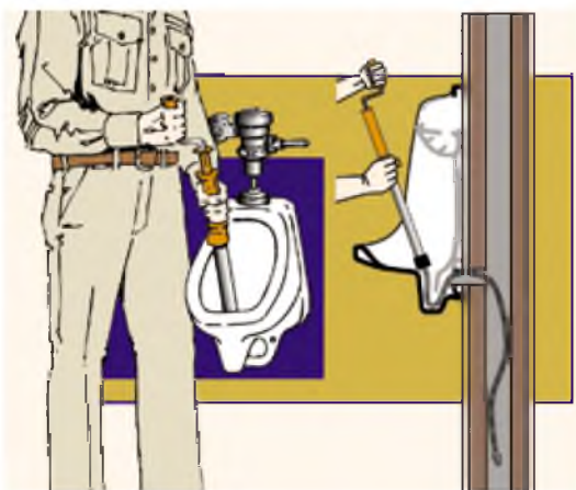
ПРОЧИСТКА ЗАСОРА ПИССУАРА
