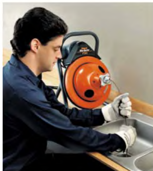
ПРОЧИСТКА СЛИВА РАКОВИНЫ С ИСПОЛЬЗОВАНИЕМ СПИРАЛИ 6 ММ В БАРАБАНЕ (J50)
