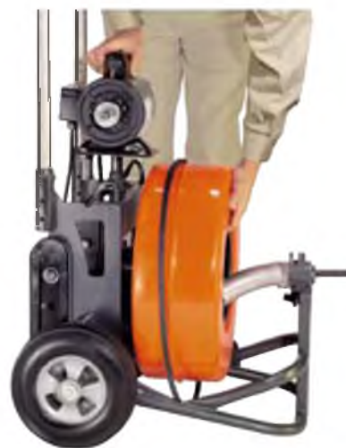
БАРАБАН ЛЕГКО СНИМАЕТСЯ (МАЛЫЙ БАРАБАН ИСПОЛЬЗУЕТСЯ ДЛЯ ТРУБ ОТ 50ММ)
